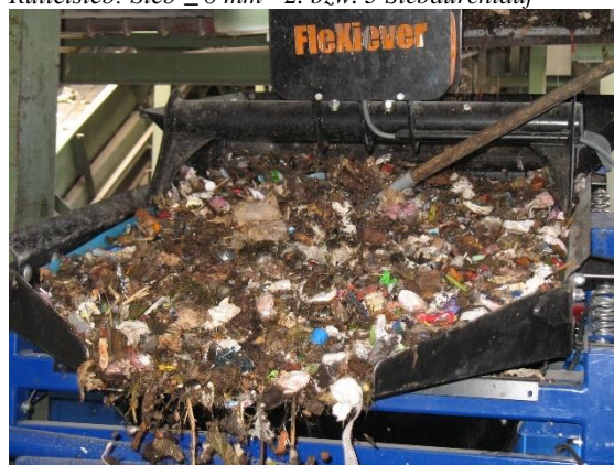
Bild 14: Rüttelsieb: Sieb \leq 8 mm - 2. bzw. 3. Siebdurchlauf
