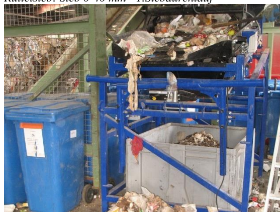
Bild 8: Rüttelsieb: Sieb 0-40 mm - 1. Siebdurchlauf
