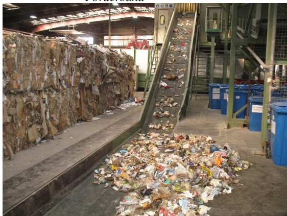
Bild 11: Sortieranlage: Siebüberlauf > 40 mm, Rinne und Förderband
