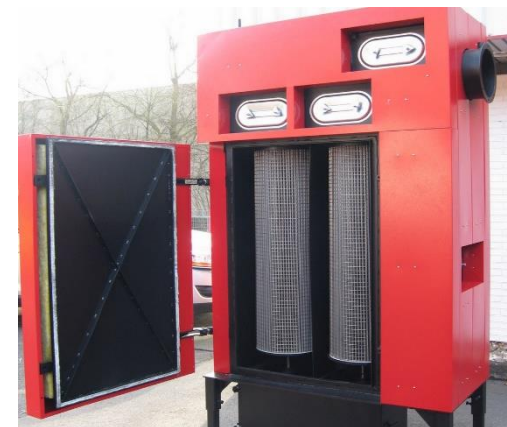
Elektro/Gewebefilter, Quelle: Bioflamm
